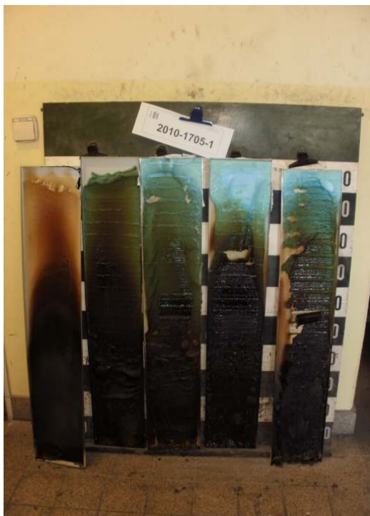
Aussehen der Probe A nach dem Brandschachtversuch
