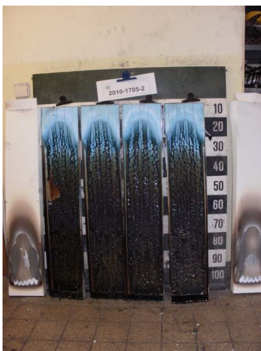
Aussehen der Probe B nach dem Brandschachtversuch
