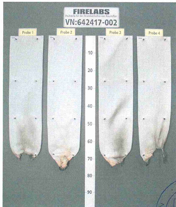
Bild 4 Aussehen des Probekörpers nach dem Brandversuch
